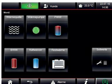
Einfach zu bedienende SPS-Regelung mit Farb-Touch-Display
